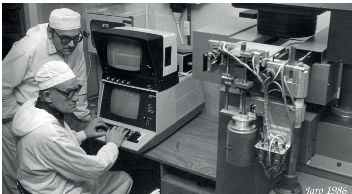
Jaro 1986 – Tesla Rožnov (pracoviště fotolitografie – u zařízení pro přímé krokování na SiD). Ladislav Štoksa (vpředu) a Pavel Hon.
